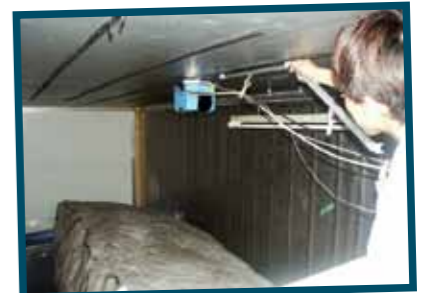
レーザースキャナによる貯雪の形状測定。これで雪の残り具合が分かります!
