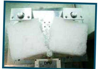
雪の強度計測。これで雪の頑固さ加減がわかります。
